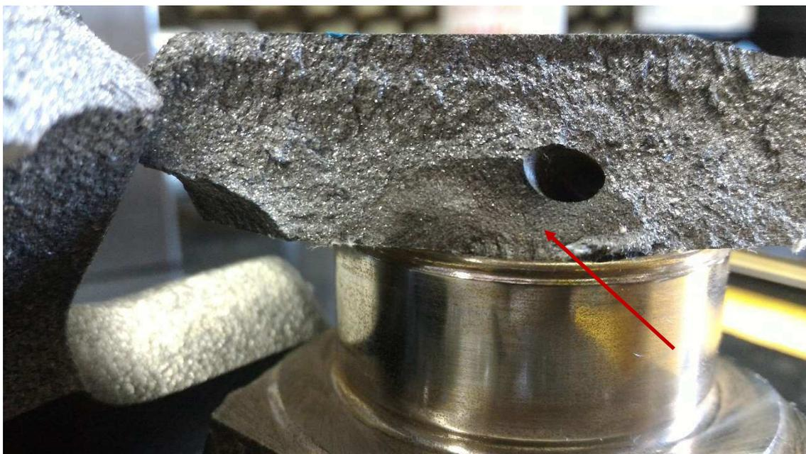
Figura 6.12 – Corpo de prova fraturado após o ensaio.
