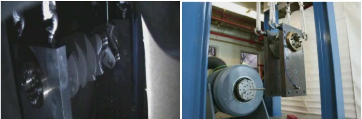
Figura 2.14 – Imagem do equipamento em ensaio de torção à esquerda e flexão à direita (CALLIES, 2017).
