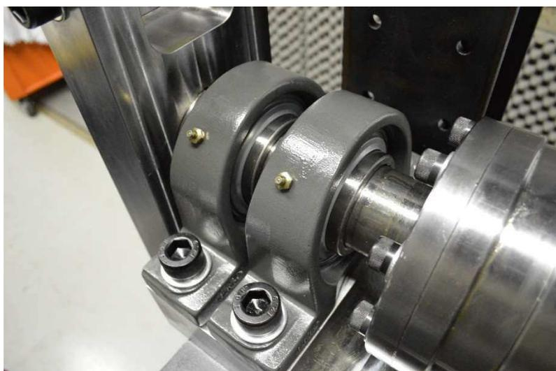
Figura 6.4 – Mancais de suporte do núcleo de torção da bancada de ensaio.
