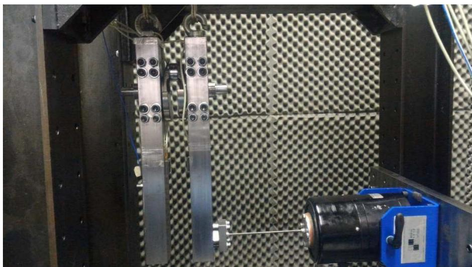
Figura 6.3 – Núcleo de flexão da bancada de ensaio desenvolvida.
